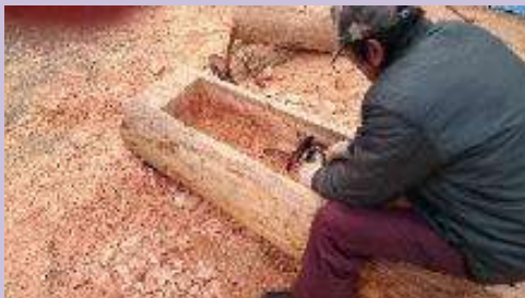
水車の脇にある水場に置く水溜も、古くなれば、合間を見て自分たちでつくり替える。
